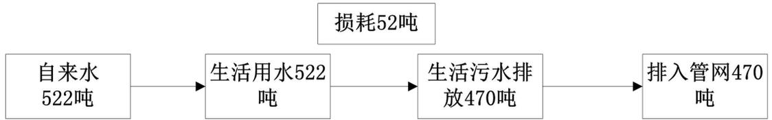
图3-3 本项目水平衡图
